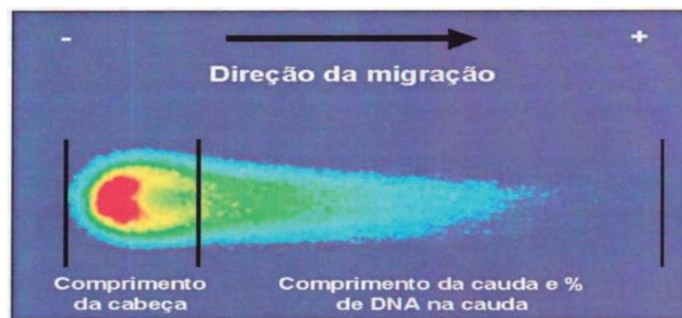
Figura 6. Estrutura de um cometa com cabeça e cauda. Fonte: Gontijo; Tice (2003).
