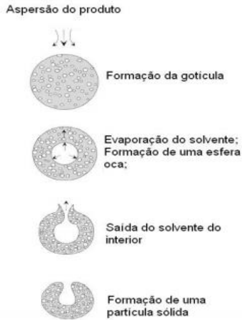
Figura 2. Formação de partícula por secagem por aspersão. (Fonte: OLIVEIRA; PETROVICK, 2009).
