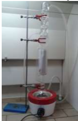
Figura 5. Foto ilustrativa do sistema soxhlet utilizado para a extração dos óleos vegetais.
