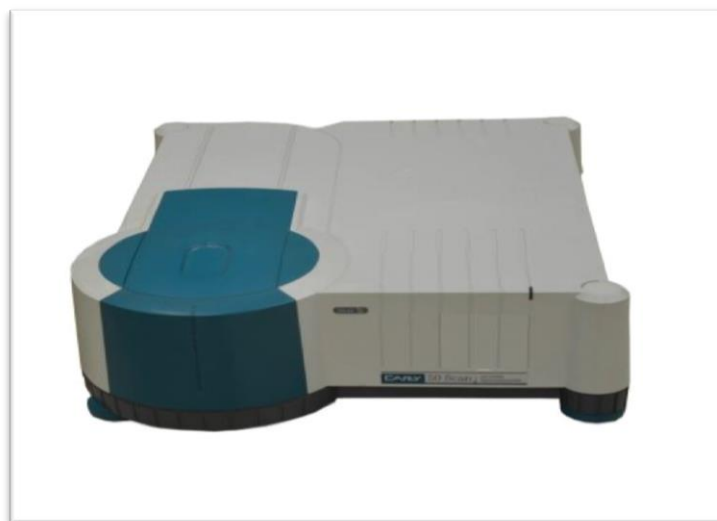
Figura 11 - Espectrofotômetro usado nas medidas de UV-Vis dos compósitos PVDF/Er 2 O 3 .
