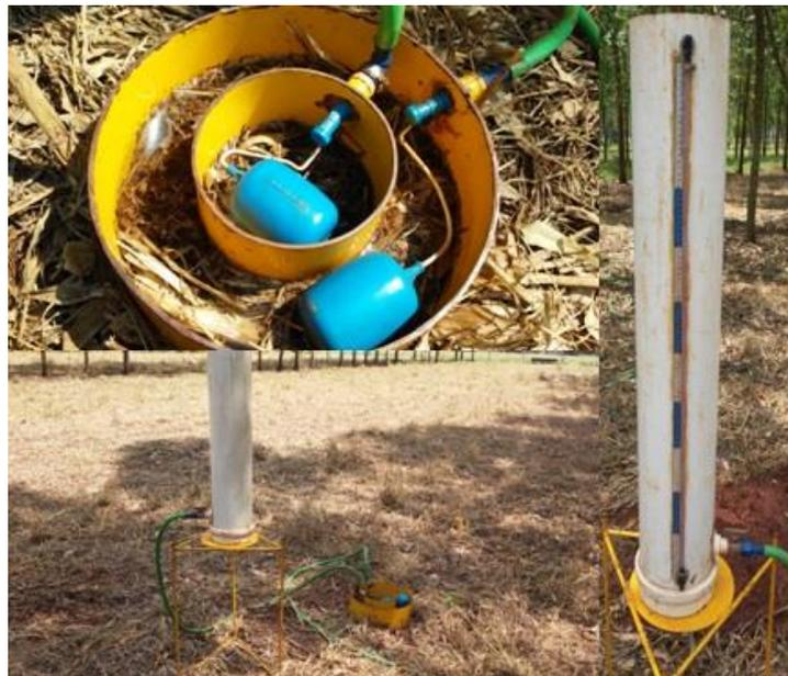
**Figura 2.** Sistema utilizado para aferir a taxa de infiltração de água no solo em Ponta Porã - MS.
