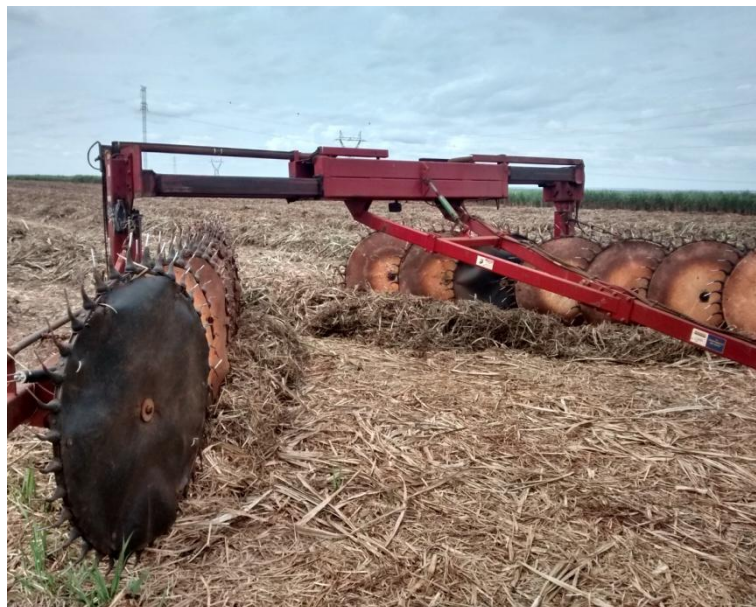
FIGURA 3. Ancinho enleirador, da marca New Holland, modelo H5980, usado na formação das leiras de palhço.
