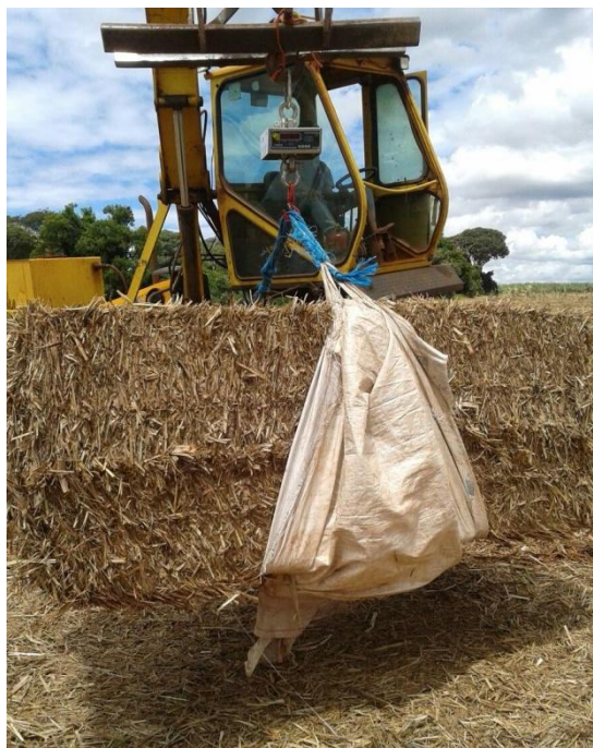
FIGURA 6. Pesagem dos fardos no campo com o auxílio do dinamômetro.
