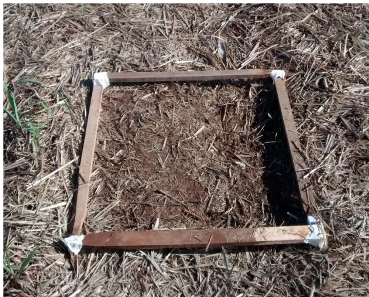
FIGURA 1. Armação para se determinar a produtividade de palhço de cana-de-açúcar.
