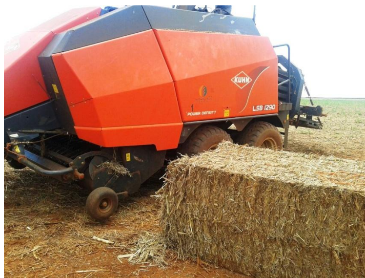
FIGURA 5. Enfardadora Kuhn, modelo LSB 1290, utilizada para recolhimento de palhiço de cana-de-açúcar.
