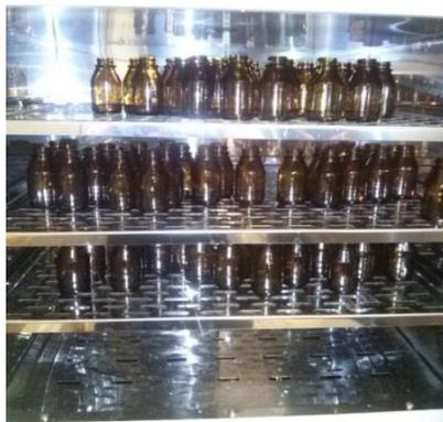
**Figura 4:** Amostras de biodiesel dentro da estufa para iniciar o processo de termodegradação
