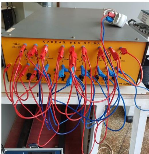
Figura 09: Bancada de Resistores. Fonte: Própria (2018).
