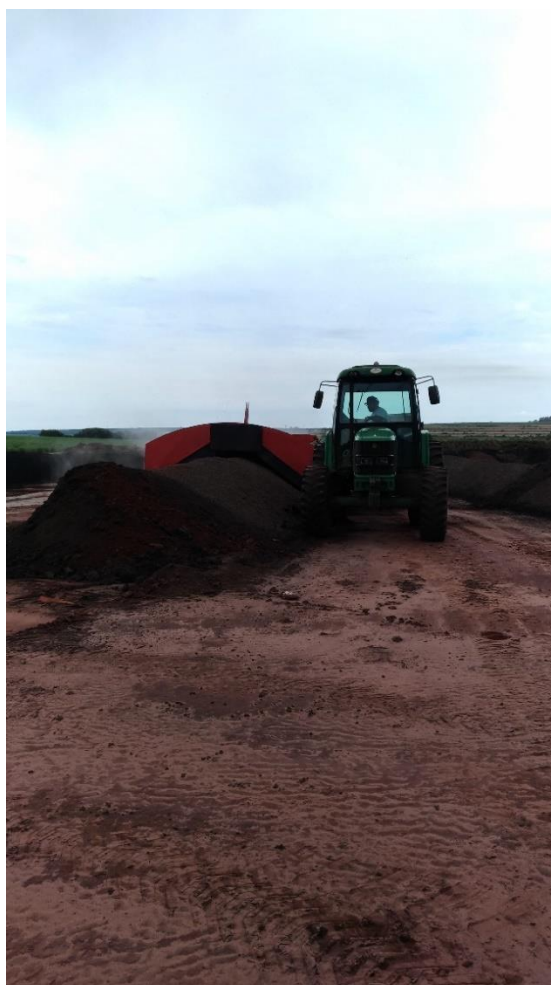
Figura 5. Realização do revolvimento com o compostador.
