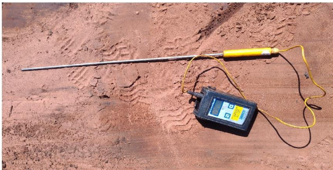
Figura 12. Termômetro para medir a temperatura da leira.
