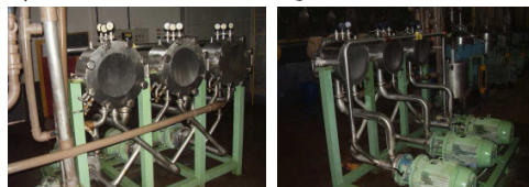
FOTO 09 - HIDROS UTILIZADOS PARA A CONCENTRAÇÃO DO AMIDO (FRENTE NA FOTO ESQUERDA E VERSO NA DIREITA)
