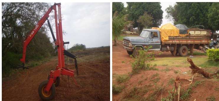
FOTO 07 – GUINCHO UTILIZADO PARA ERGUER OS BIG BAGS E CAMINHÃO PARA O TRANSPORTE
