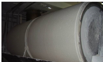
FOTO 12 - FILTRO À VÁCUO: SEPARA O AMIDO DA ÁGUA
