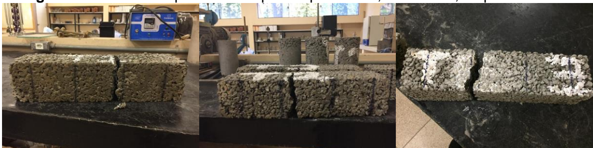
Figura 8 - Forma de ruptura nos corpos de prova S00, S05 e S10, respectivamente
