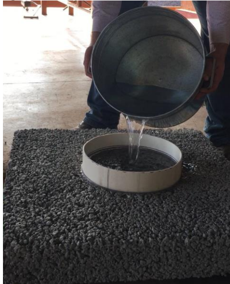
Figura 10 - Ensaio de permeabilidade
