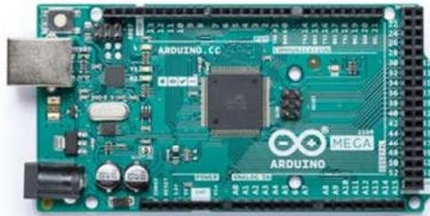
**Figura 19.** Microcontrolador Arduino Mega, Fonte: Arduino Project Foundation
