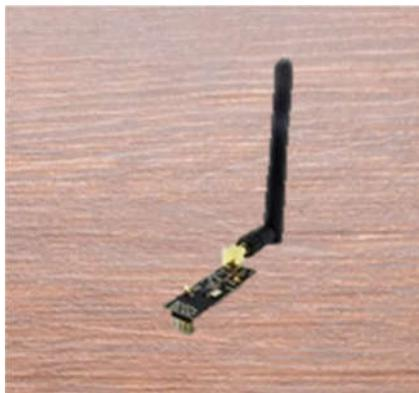
**Figura 15.** Módulo transceptor NRF24L01, Fonte: Autor
