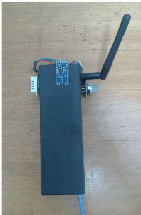
**Figura 26.** Protótipo do Emissor, com os sensores à mostra. Fonte: Autor
