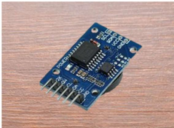
**Figura 12.** Módulo RTC, Fonte: Autor
