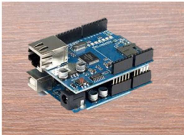
**Figura 10.** Microcontrolador Arduino Uno (baixo) e Shield Ethernet (cima), Fonte: Autor.
