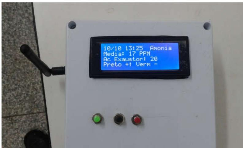
**Figura 34.** Central Receptora com display, botões e antena. Fonte: Autor
