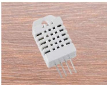
**Figura 6.** Sensor de Temperatura e Umidade Relativa do ar DHT22, Fonte: Autor
