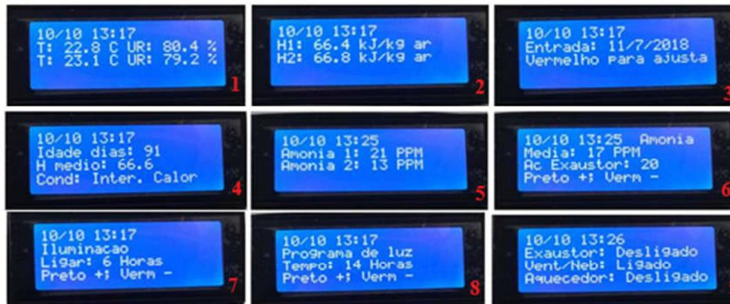
**Figura 36.** Telas apresentadas no Display da Central Eletrônica. Fonte: Autor
