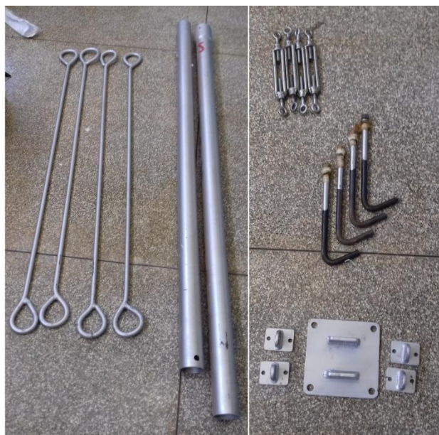
Figura 3 – Tubos e ancora da torre de sustentação do aerogerador.
