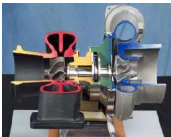
Figura 21 - Turbina a Gás radial.
