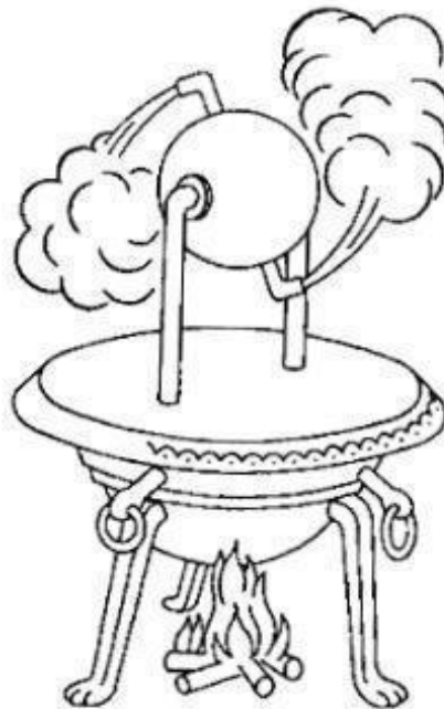
Figura 1 - Aeolipile criado por Hero
