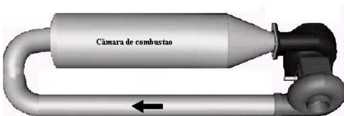
Figura 25 – Esquematização de microturbina derivada de turbocompressor
