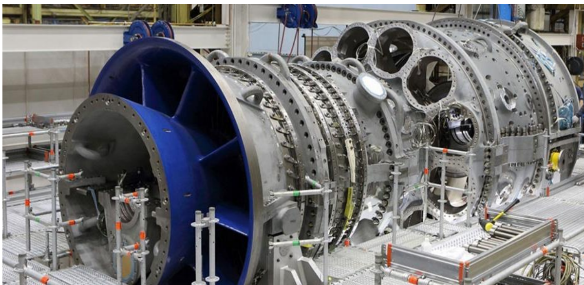
Figura 23 - Turbina a gás heavy duty GE 7HA.
