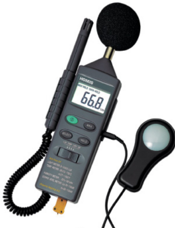
Figura 19 – Foto do decibelímetro multifunções HOMIS 425-A.
