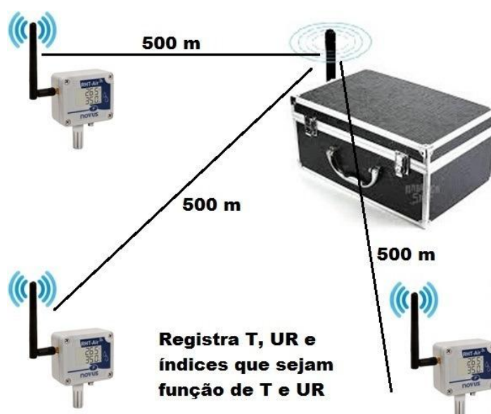
Figura 2. Esquema de funcionamento dos sensores wireless utilizados na pesquisa.
