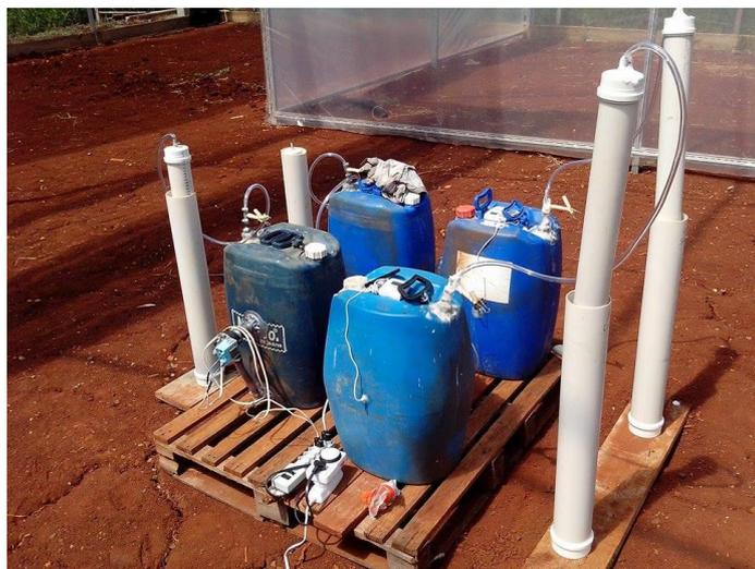
Figura 8. Biodigestores e gasômetros montados no experimento.
