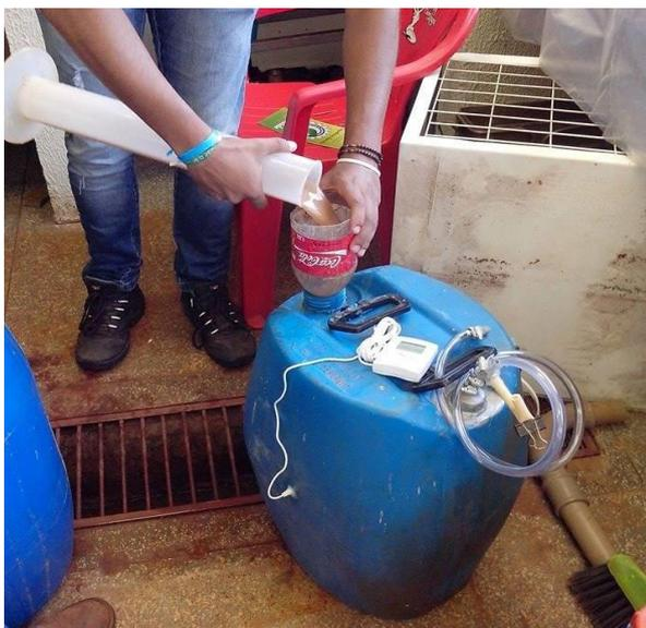
Figura 9. Termômetro de máxima e mínima instalado em biodigestor.
