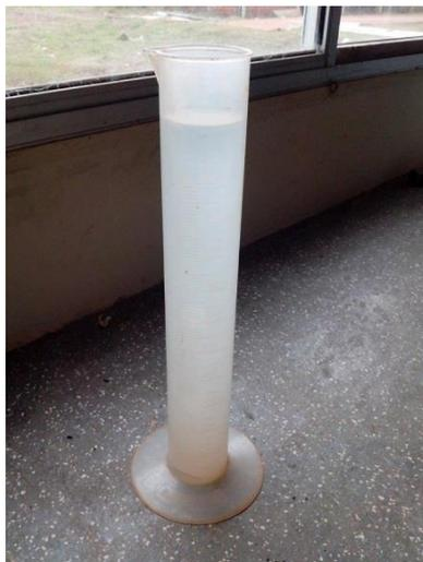
Figura 11. Proveta utilizada para determinação da fração decantável da descarga de fundo.
