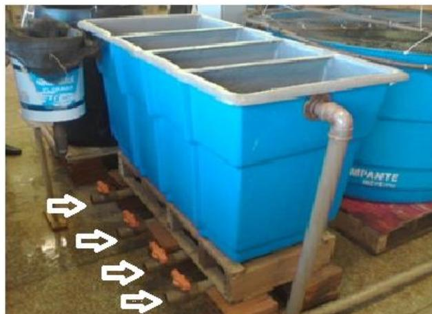
Figura 3. Decantador e filtro de sólidos.
