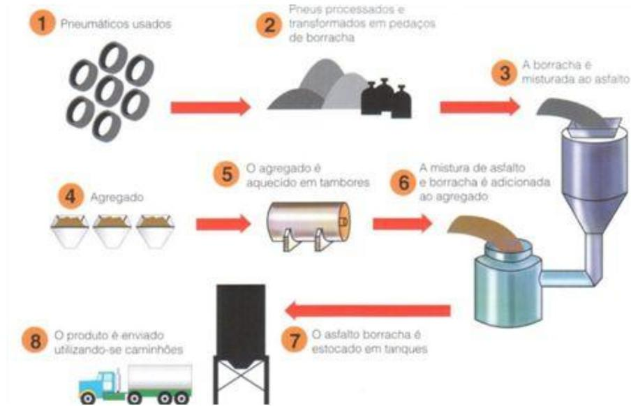
Figura 4. Processo de fabricação do asfalto borracha.
