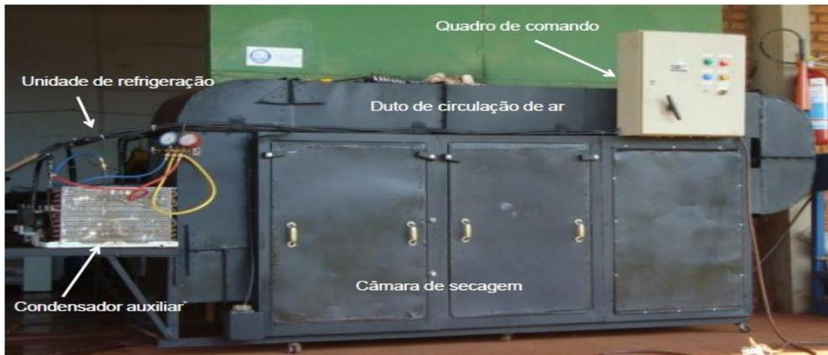
**Figura 4** – Vista panorâmica do protótipo do secador, onde pode ser visto o quadro de comando (painel de controle).
