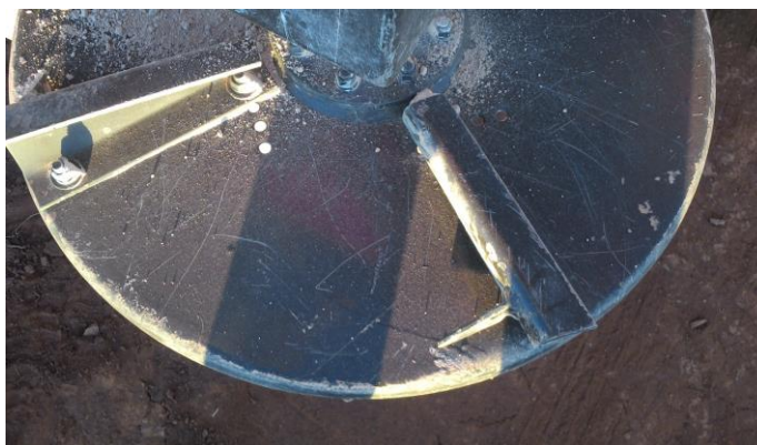
FIGURA 1. Disco centrífugo com aletas na posição 2.
