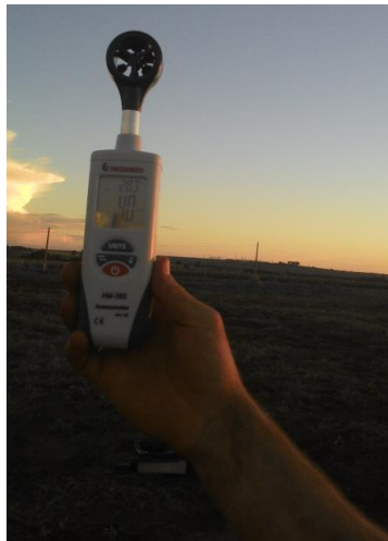
FIGURA 3. Termoanemômetro digital portátil da marca HIGHMED – Modelo HM-380.
