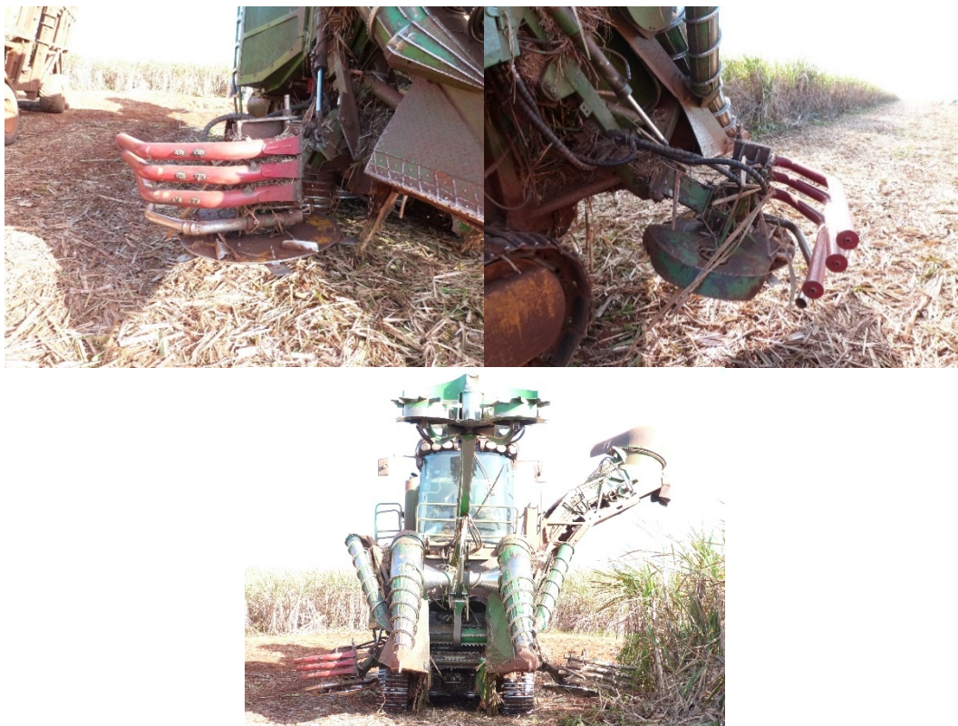
FIGURA 1. Colhedora e dispositivo Policana 2L.
