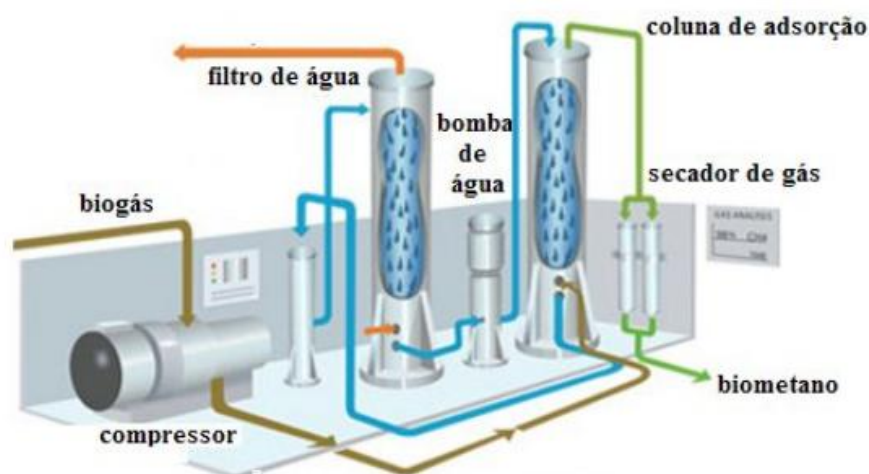
Figura 26: Esquema de purificação – lavagem com água sob pressão.
