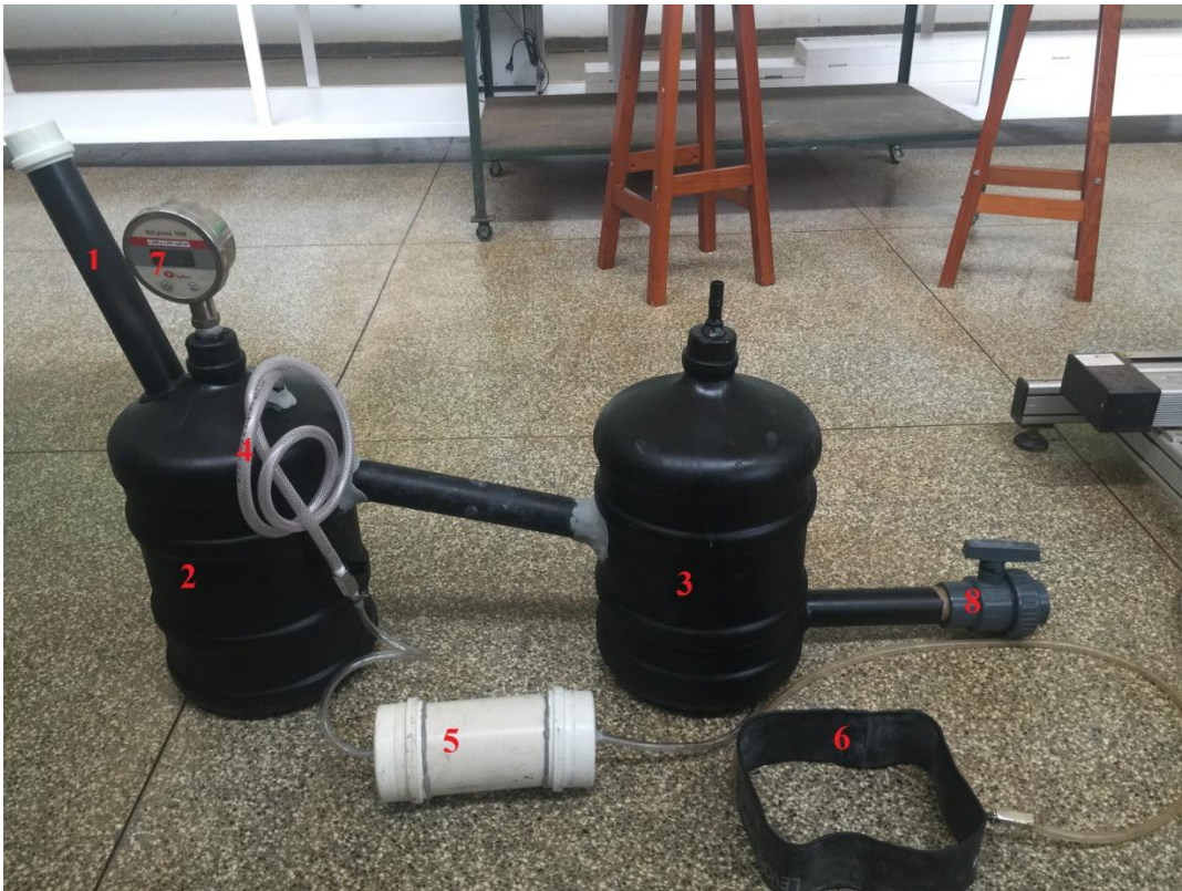
Figura 42: Sistema de produção de biogás contendo um sistema de filtragem e um sistema de armazenamento.
