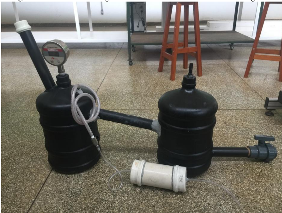
Figura 38: Sistema de filtragem de carvão ativado introduzido ao biodigestor.
