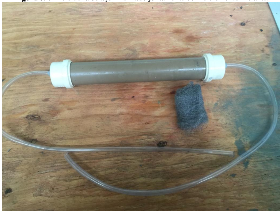
Figura 39: Filtro de lã de aço finalizado juntamente com o elemento filtrante.
