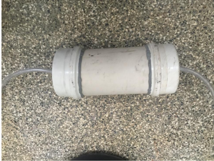
Figura 37: Filtro de PVC contendo carvão ativado.
