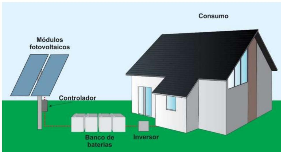
**Figura 10.** Esquemática de um sistema isolado (Off-Grid).
