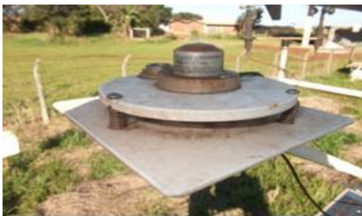
Figura 6 - Piranômetro no campus da UFGD.
