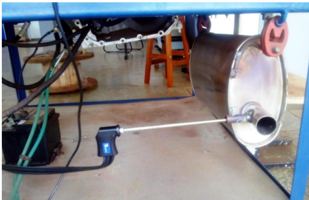
Figura 23- Balança e reservatório de combustível.
