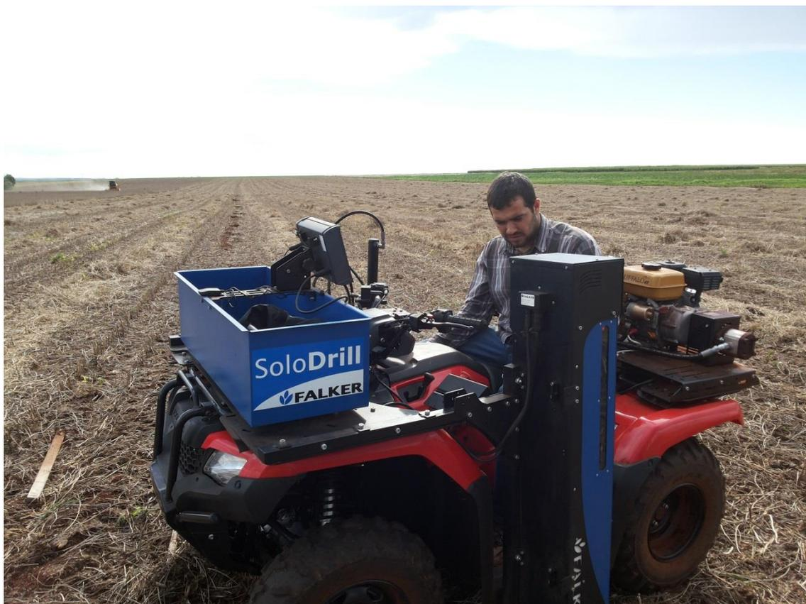
FIGURA 2. Conjunto utilizado para amostragem da resistência à penetração.
