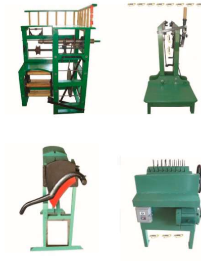
Figura 12: Máquina para amarrar as vassouras, prensa para costura, guilhotina para corte das fibras e para retirada das sementes da palha.
