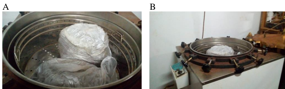
Figura 5. A) Substratos acondicionados em sacos PEAD para autoclave. B) Autoclave vertical com substratos para autoclave.
