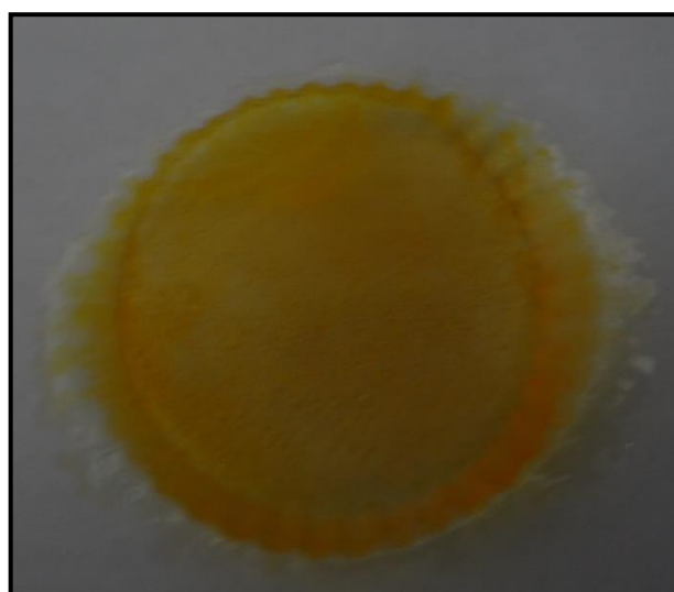
Figura 8: Película elaborada com quitosana PVA e óleo de bocaiúva.
