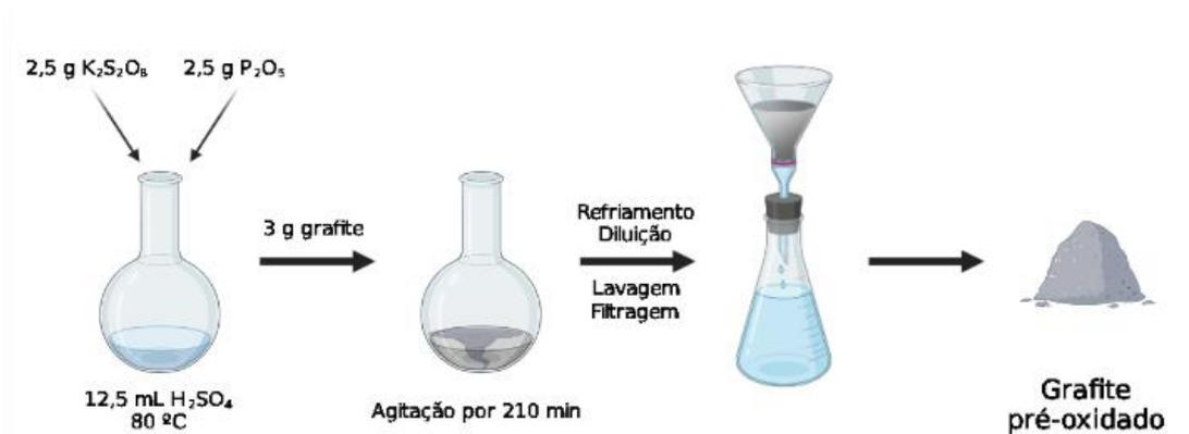
**Figura 9:** Esquema de síntese da pré-oxidação do grafite. Fonte: Autor.
