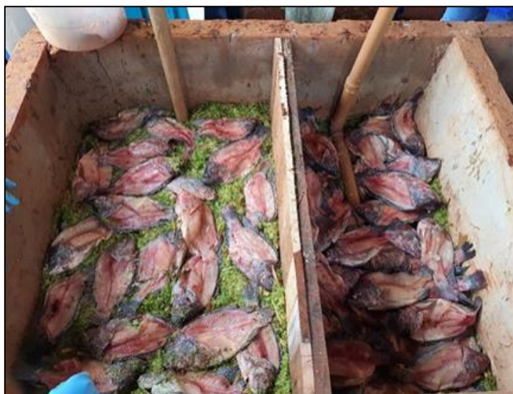
Figura 4. Disposição dos resíduos em camadas nas composteiras de alvenaria. Detalhe para visualização do cano de condução da aeração forçada.
