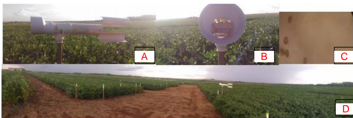
FIGURA 1. Visão ilustrativa do ensaio experimental, mostrando coletor de esporos (A), fungo coletor com lâmina de captura de esporos (B), esporos coletados (C), área experimental (D).
