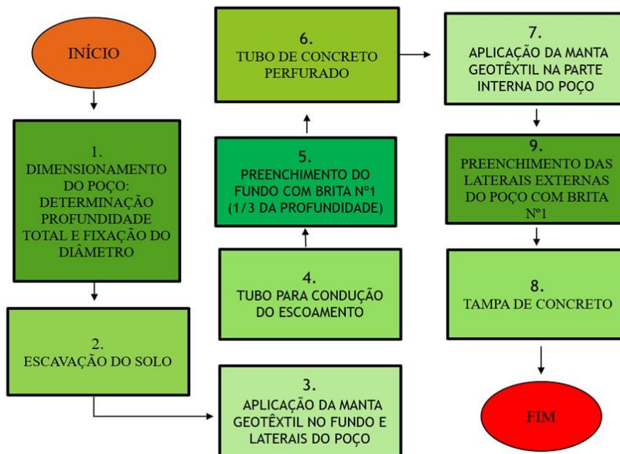
Figura B - Fluxograma de atividades para execução de poço de infiltração
