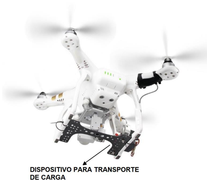
Figura 7 – Dispositivo de acoplamento para transporte de carga
