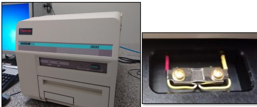
Figura 10. Leitora TLD Harshaw 3500HT (à esquerda) e porta amostra em platina (à direita) onde as amostras são aquecidas.
