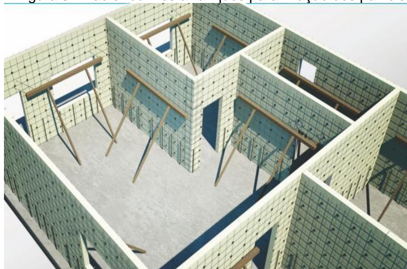
Figura 3 - Radier com os arranques para fixação dos painéis
