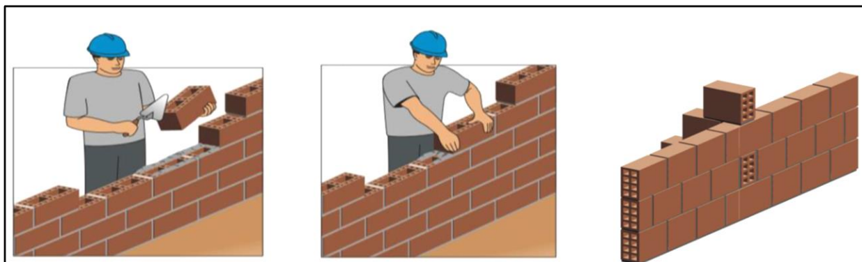
Figura 1 – Assentamento das alvenarias e execução de fiadas
