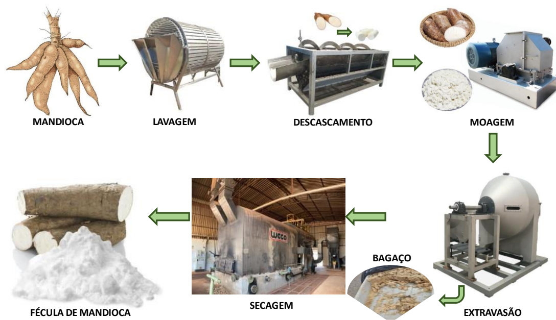
Figura 1- Processo de Fabricação da Fécula de mandioca
