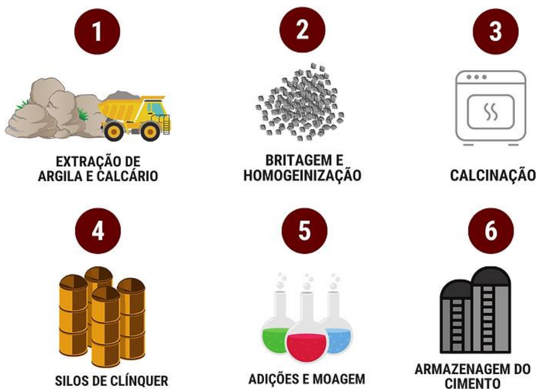
Figura 2 - Processo de fabricação do cimento
