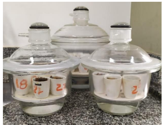
Figura 6 – Amostras nos dessecadores
