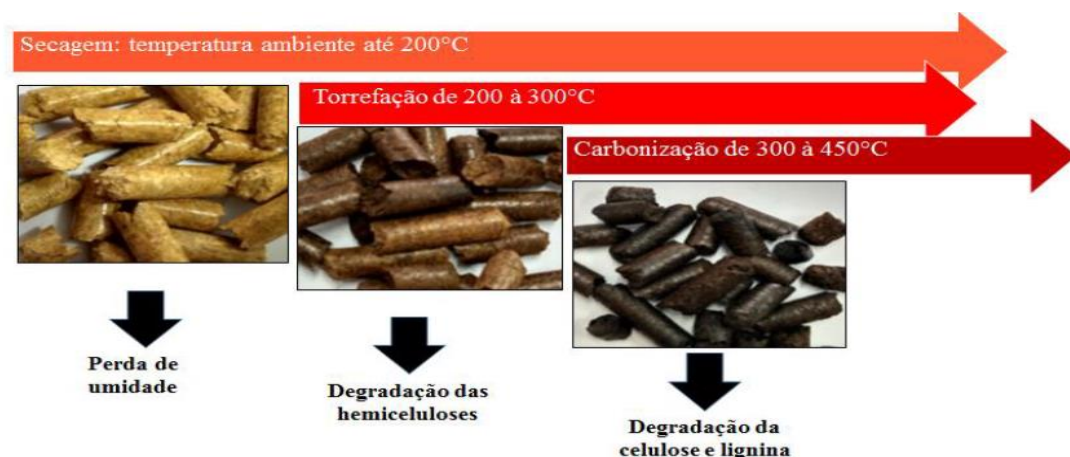
Figura 3 – Alteração da coloração conforme aumento da temperatura na torrefação
