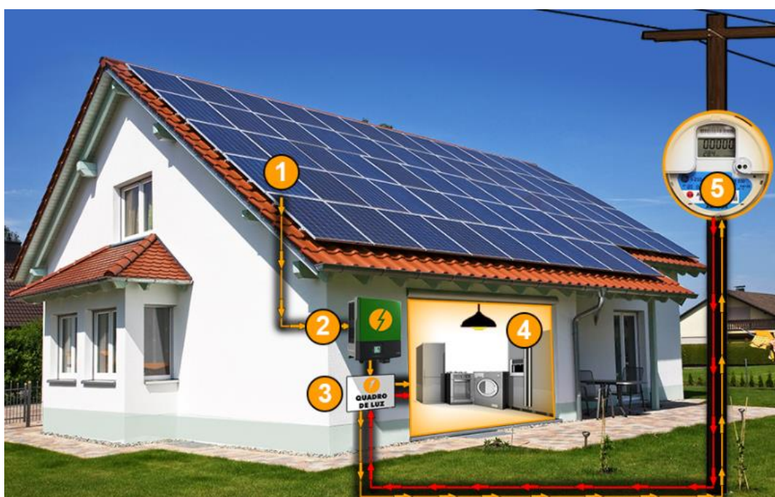
Figura 3: Funcionamento de um sistema fotovoltaico on grid
