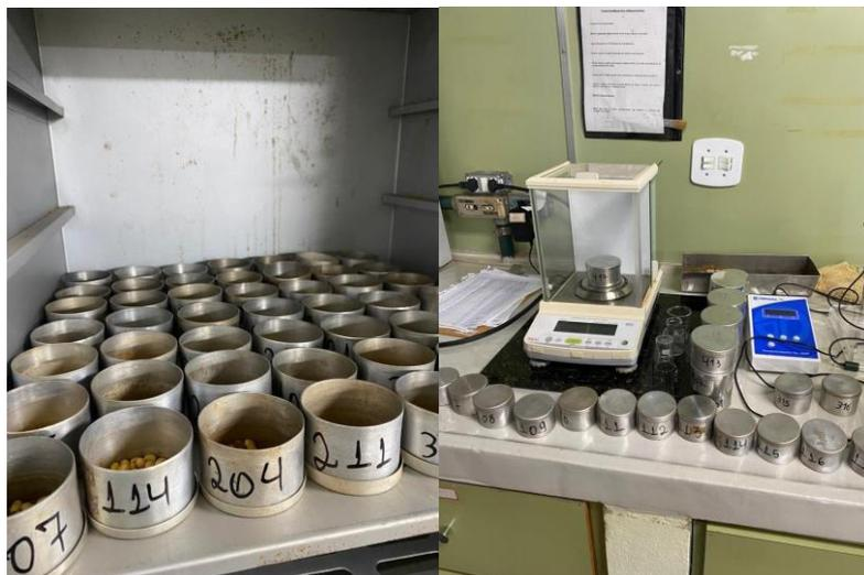
**Figura 4.** Análises realizadas para a determinação do teor de água, realizada no laboratório de sementes da FCA.
