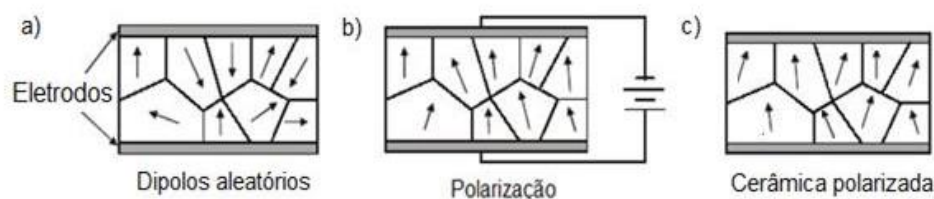
Figura 4: Esquema representativo de uma cerâmica ferroelétrica a) não polarizada, b) no processo de polarização e c) polarizada. Fonte: (Zapata, 2015).
