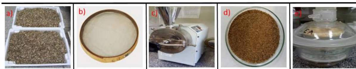
Figura 6 Vagem de soja, onde: a) recepção; b) peneiramento e limpeza; c) trituração; d) vagem triturada e e) armazenadas em dessecador.
