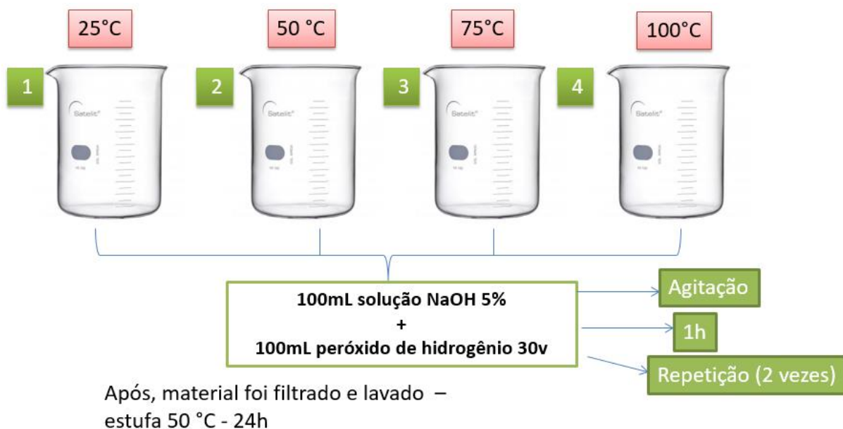
Figura 7 Esquema representativo do processo de branqueamento das fibras de vagem de soja mercerizadas.
