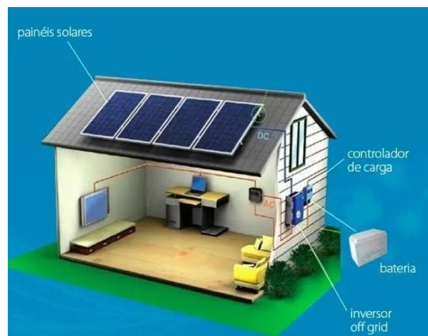
Figura 6. Sistema fotovoltaico off-grid.
