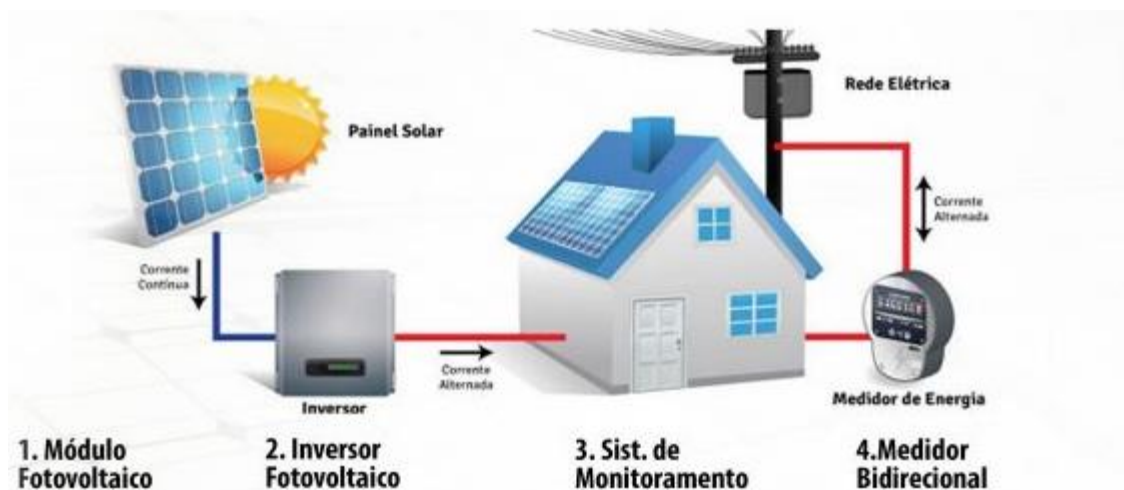
Figura 7. Funcionamento do sistema solar fotovoltaico On-Grid
