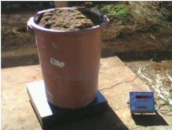
1-Procedimento adotado para pesagem das leiras e estimativa do volume
