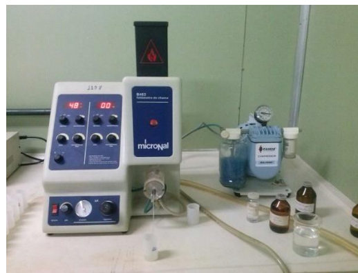
Figura 12. Análise do teor de potássio em fotômetro de chama.
