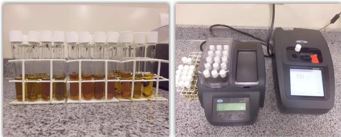
Figura 9. Tubos após análise da demanda química de oxigênio utilizando digestor e espectrofotômetro.
