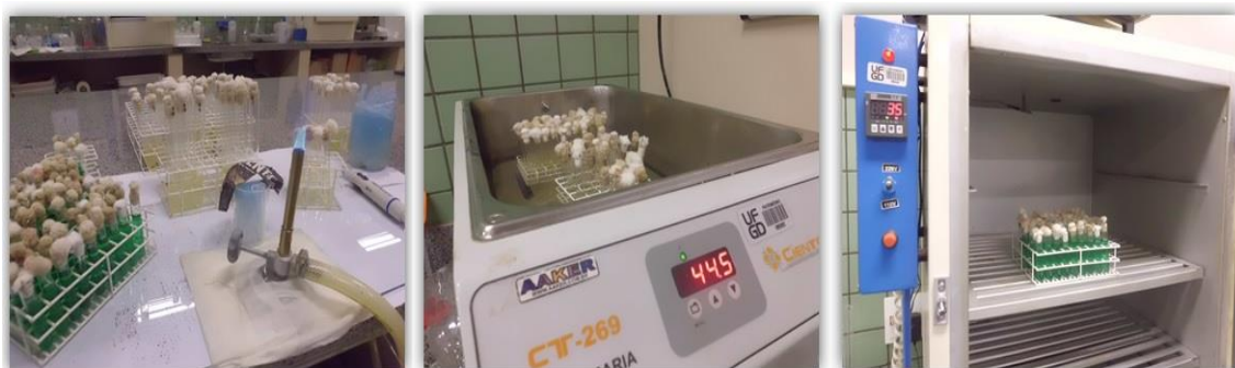
Figura 10. Análise do NMP de coliformes pela técnica dos tubos múltiplos.
