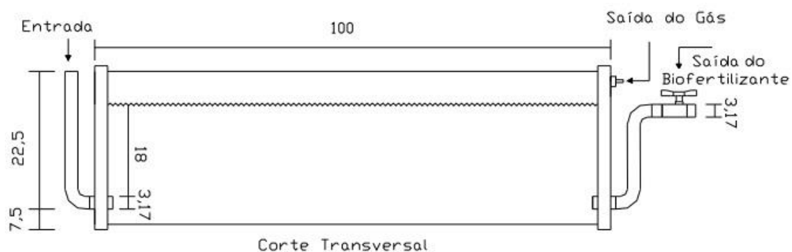
Figura 1. Corte transversal de biodigestor semi-contínuo.
