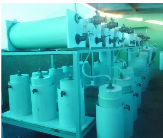
Figura 3. Biodigestores experimentais de modelo semi-contínuos.
