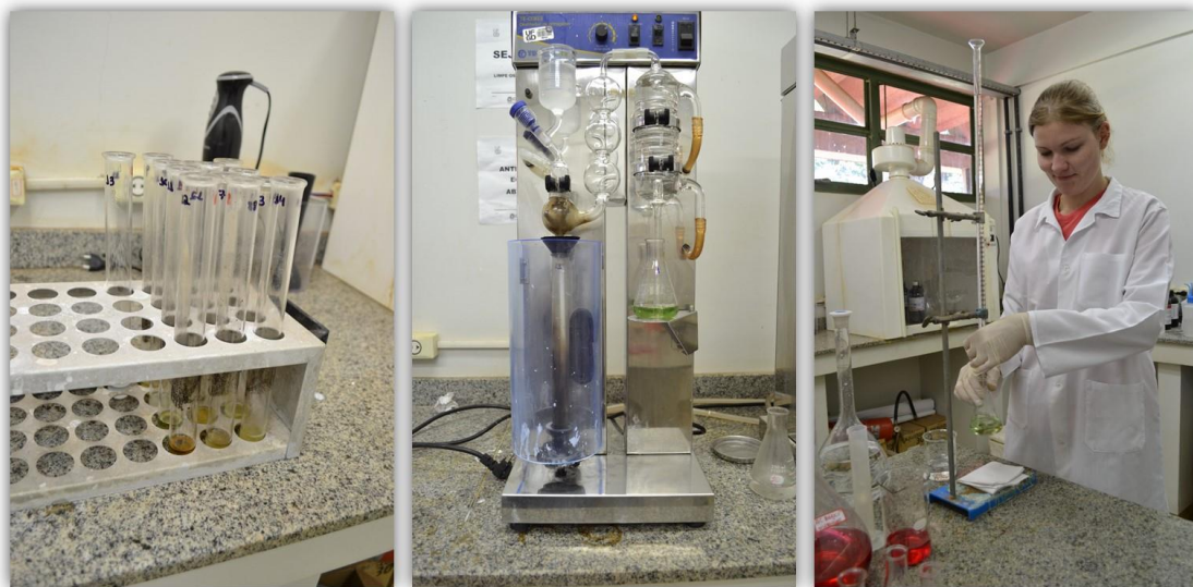
Figura 13. Tubos após digestão sulfúrica, destilação e titulação para determinar o teor de nitrogênio pelo método de Kjeldahl.
