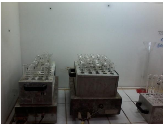
Figura 11. Digestão ácida de material para análise de fósforo e potássio.
