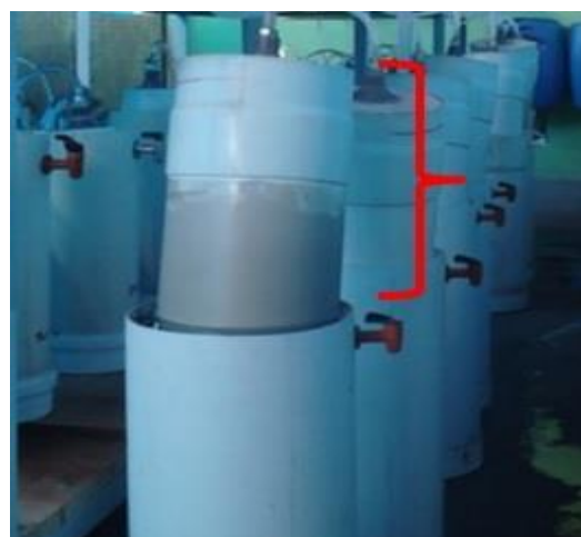
Figura 4. Deslocamento vertical do gasômetro após produção de biogás.
