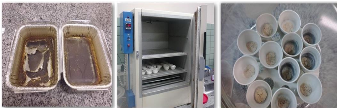
Figura 6. Amostra de entrada e saída dos biodigestores em bandejas após secagem em estufa de circulação forçada, análise de sólidos totais em estufa a 105° e cadinhos após mufla para análise de sólidos voláteis.
