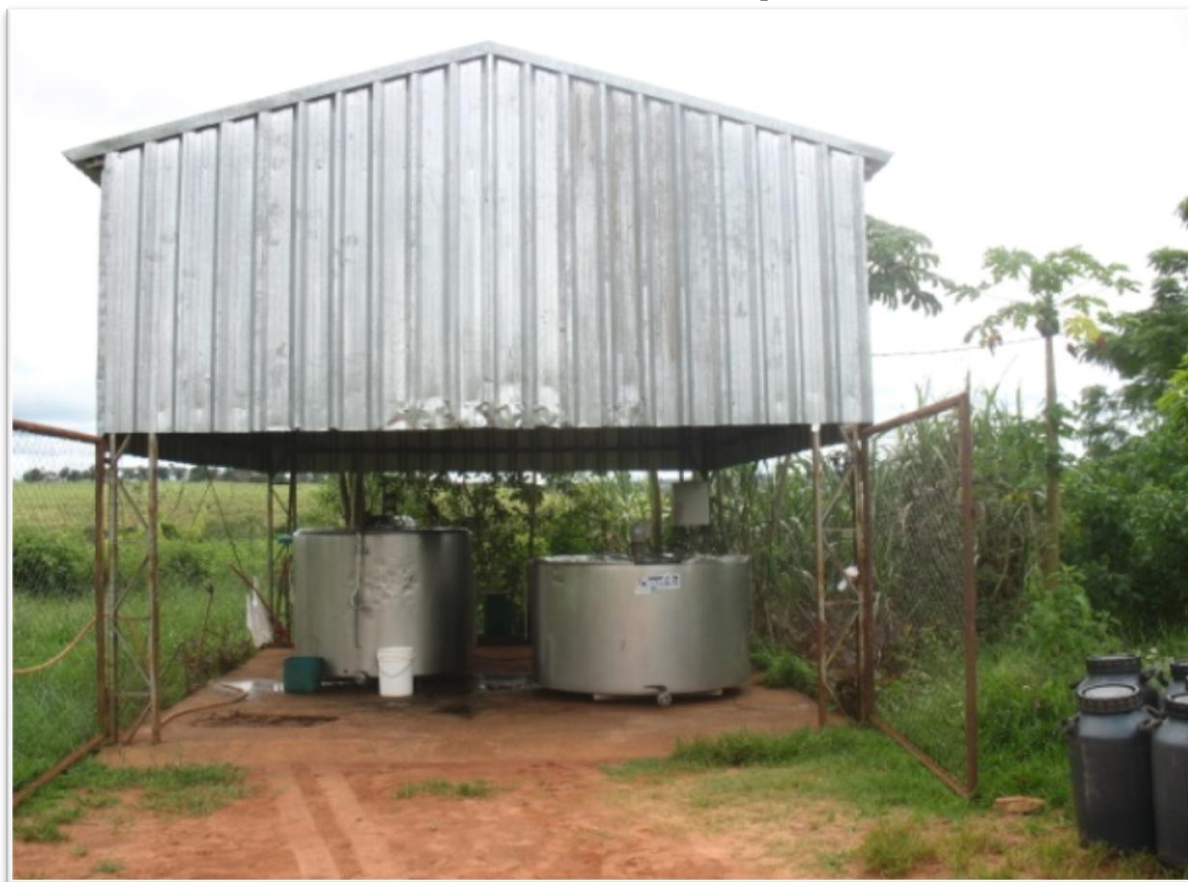
Foto 1: Mostra de resfriadores de leite, instalados em assentamento. Caso do assentamento Santa Irene, município de
