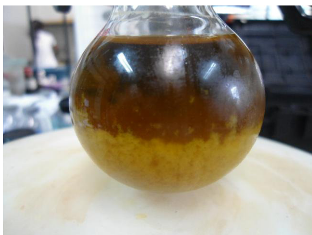
Figura 4 Imagem da síntese do cluster [\text{Cu}_4\text{OCl}_6(\text{Nic})_4] . Foto: Hellenicy Vitor Rezende.
