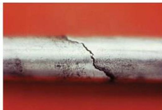
**Figura 7.** Corrosão sob tensão fraturante em tubo de aço inox AISI 304 (Fonte: GENTIL, V. Corrosão. Rio de Janeiro. Editora Guanabara Dois, 2003).
