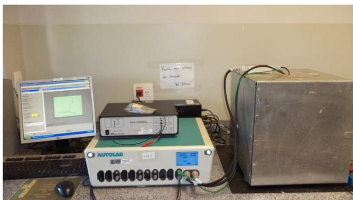
**Figura 17.** Equipamento potenciostato-galvanostato, AUTOLAB - modelo PGSTAT302N.
