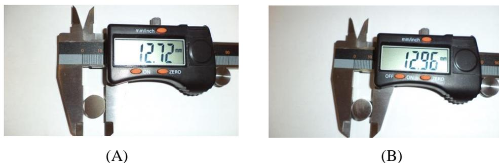
**Figura 16.** Eletrodos de trabalho. (A) Ti-4Si e (B) Ti-12Si.
