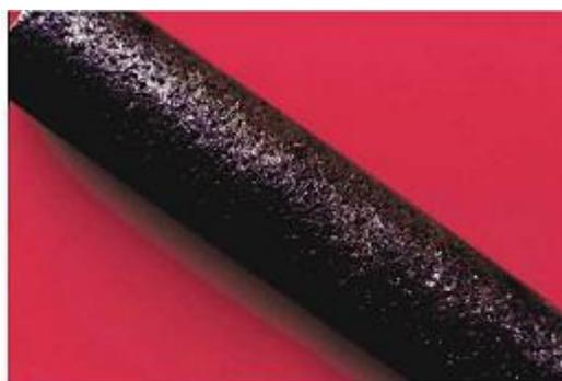
**Figura 5.** Aspecto de um tubo de aço-carbono que apresenta corrosão por pite (Fonte: GENTIL, V. Corrosão. Rio de Janeiro. Editora Guanabara Dois, 2003).
