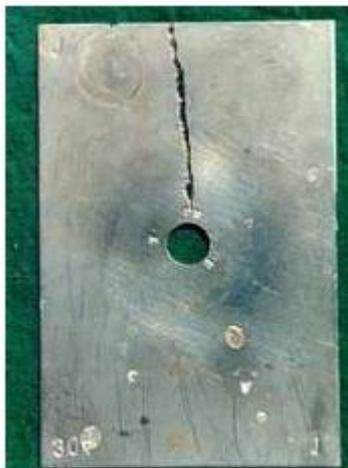
**Figura 4.** Exemplo de corrosão por fresta em um aço inoxidável (Fonte: PONTE, H. A.; MAUL, A. M. e ALVARENGA, E. A., 2000. **Análise por técnica eletroquímica da porosidade de revestimentos obtidos por processo de fosfatização sobre aço galvanizado.** Congresso Brasileiro de Corrosão – XX CONBRASCO & II SEDEMAT (20: 2000: Fortaleza). Anais. Fortaleza: ABRACO. 2000. 1 CD-ROM).
