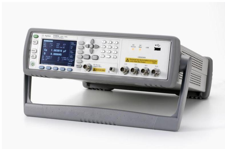
Figura 24 – Ponte RLC Agilent E4980 usado nas medidas de Constante Dielétrica dos compósitos PVDF/Ce(SO<sub>4</sub>)<sub>2</sub>.4H<sub>2</sub>O e PVDF/CeCl<sub>3</sub>.7H<sub>2</sub>O.
