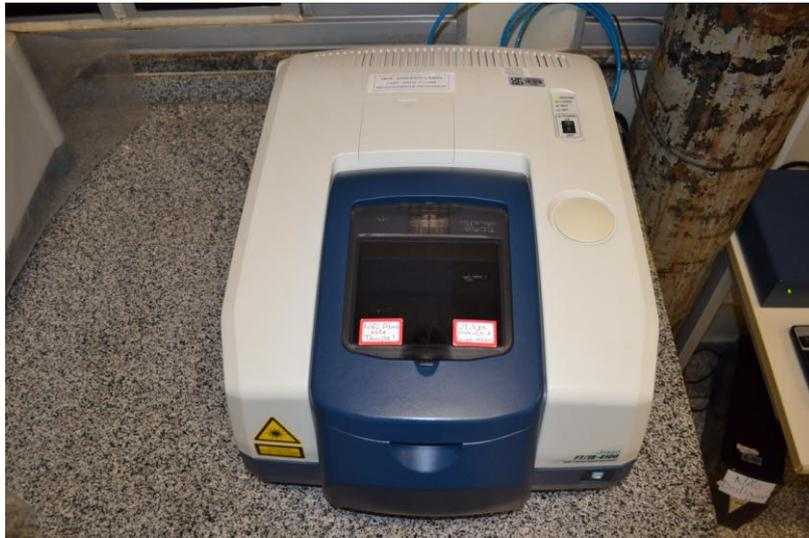
Figura 21 – Espectrofotômetro usado nas medidas de FT-IR dos compósitos PVDF/ $\text{Ce}(\text{SO}_4)_2 \cdot 4\text{H}_2\text{O}$  e PVDF/ $\text{CeCl}_3 \cdot 7\text{H}_2\text{O}$ .
