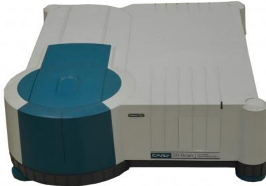
Figura 22 - Espectrofotômetro usado nas medidas de UV-Vis dos compósitos PVDF/Ce(SO<sub>4</sub>)<sub>2</sub>.4H<sub>2</sub>O e PVDF/CeCl<sub>3</sub>.7H<sub>2</sub>O.
