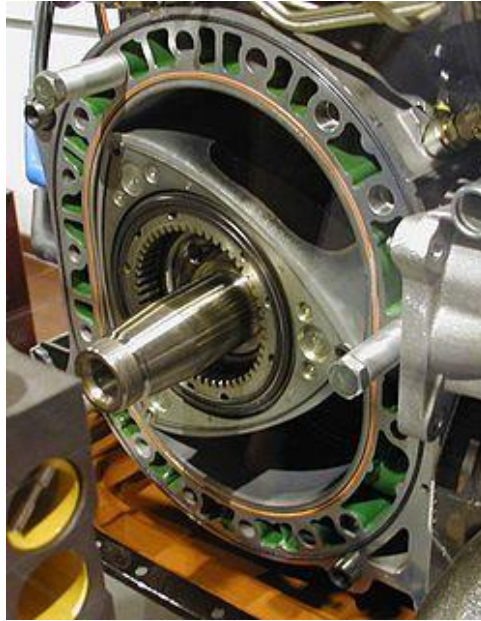
Figura 32 – Motor Wankel Disponível em: http://pt.wikipedia.org/wiki/Motor_Wankel Acesso em: março de 2014
